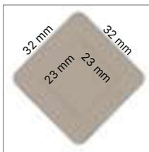
Parte inferiore della gamba in legno di frassino essiccato a sezione conica romboidale (sezione iniziale 32×32 mm, finale 23×23 mm), in spessore 2 mm.
