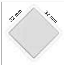
Parte superiore della gamba in tubo profilato decapato a sezione romboidale 32×32 mm, in spessore 2 mm.
